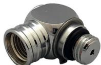
An der 1. Stufe drehbarer 90 degree Winkel aus Messing, Einbau zwischen HP-Schlauch und erster Stufe. Gedreht wird der gesamte Adapter, gut geeignet für enge Schlauchführungen zum Beispiel an Rebreathern.
